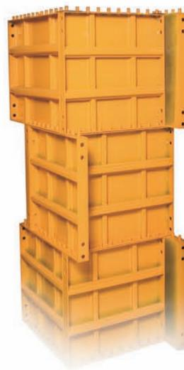
Les coffrages métallique DERCONS sont utilisées, d'une manière modulaire, pour la réalisation de poteaux de béton. Sont fabriqués en acier spécial de 2 mm d'épaisseur, avec 3, 4 ou 5 renforcements et soudure robotisée.
